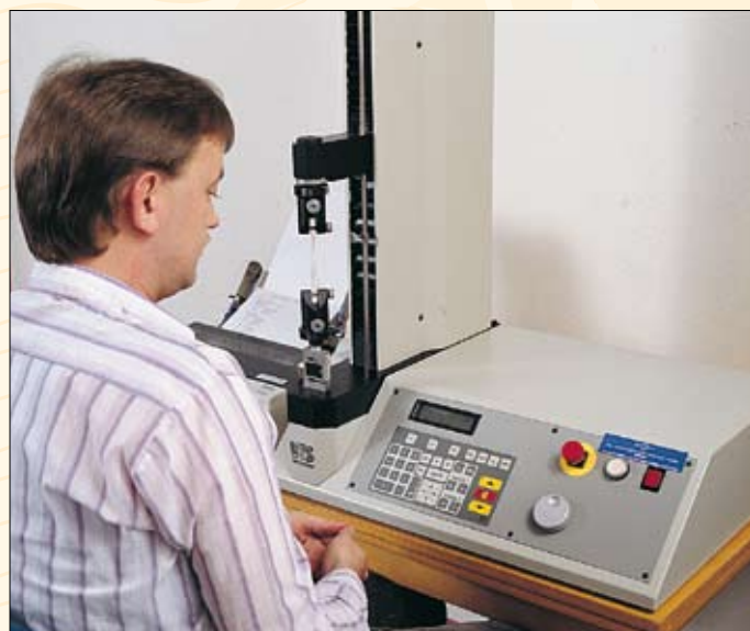
Her viser vi, hvordan et garn testes for maskebrudstyrke. Bemærk at alle garn testes i henhold til ISO 1806.
